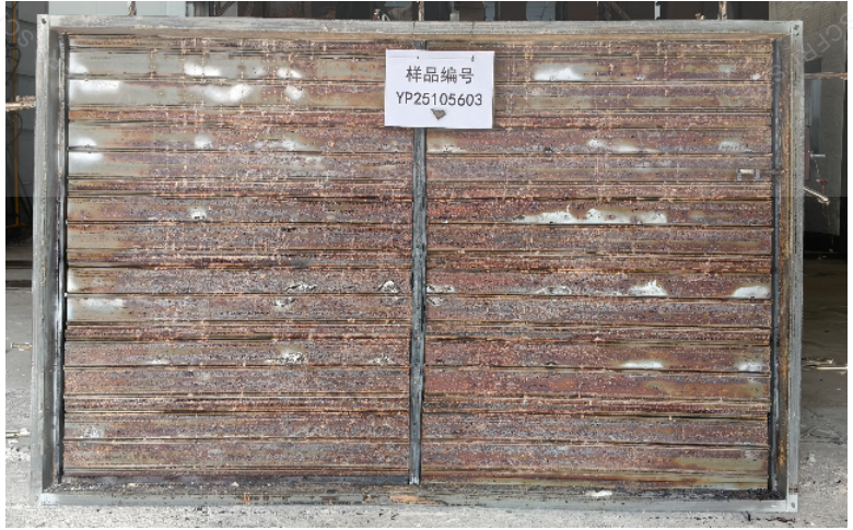
照片 2 耐火性能试验结束后试件情况
